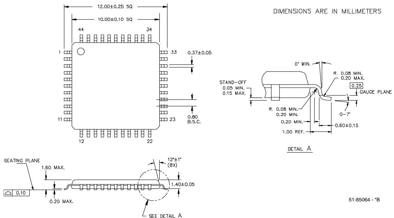
Figure 4-7. 44-Lead TQFP
